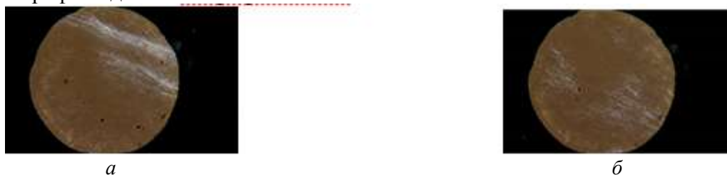
Рисунок 1 – Микрофотографии образцов в поляризованном свете C_{12}EO_4/H_2O/dec/Хум (а) и C_{12}EO_4/(H_2O+bCD)/dec/Хум (б), \times 100
