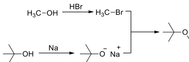
Если в первой и второй стадиях поменять спирты местами, то метилат-анион, полученный из метанола, не сможет нуклеофильно атаковать *трет*-бутилбромид (п. 2), поэтому произойдет реакция отщепления и получится изобутилен.
