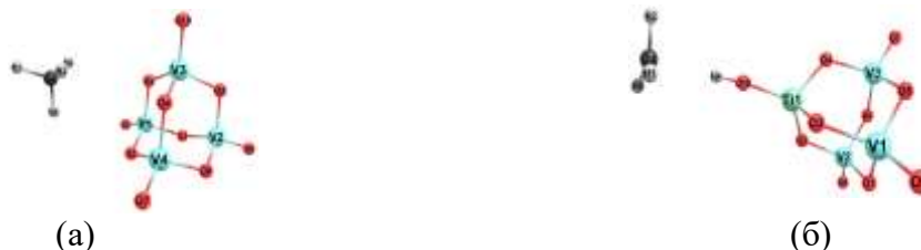
Рис. 1. (а) Оптимизированные структуры метана и кластера V_4O_{10} ; (б) Структура переходного состояния метана с кластером V_3TiO_{10} .
