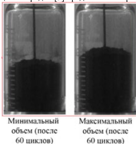
Рис. Характерное изменение объема МГ засыпки в процессе сорбции водорода. Иллюстрация взята из работы [3]
